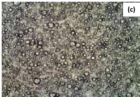
Gambar 3. Hasil uji mikroskopi pada komposisi VCO 15%, Lesitin 1% Xanthan Gum (a) 0,05%, (b) 0,1% dan (c) 0,15%
