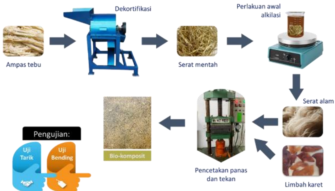
Gambar 2. Tahapan Penelitian Pembuatan Bio-Komposit dari Ampas Tebu dengan Matriks Karet Jenis Ribbed Smoked Sheet (RSS) Grade Cutting .
