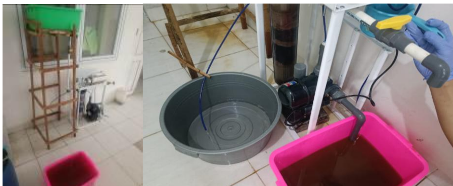
Gambar 6. Pengolahan air limbah melalui proses proses netralisasi dan UF
